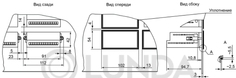
Рисунок 4.8 – Прибор в корпусе Щ2, установленный в щит толщиной 3 мм
