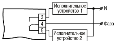
Рисунок 5.3 – Схема подключения нагрузки к ВУ типа Р
