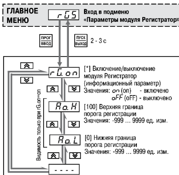
Рисунок 8.5 – Параметры регистратора в канале
