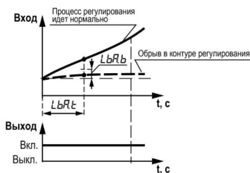
Рисунок 7.4 – Диагностика обрыва в контуре регулирования
