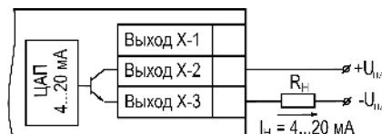
Рисунок 5.26 – Подключение к ВУ типа «И»
