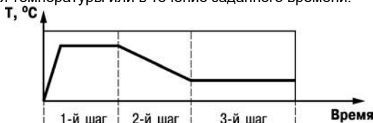
Рисунок 3.2 – Пример Программы технолога для TRM151-09
