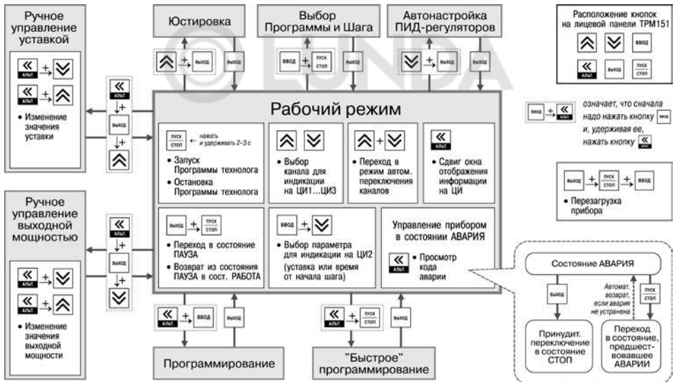
Рисунок 5.2 – Схема переключения режимов прибора
