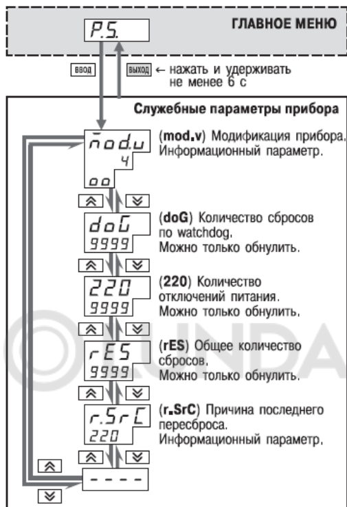
Рисунок 11.21 - Схема доступа к службным параметрам прибора
