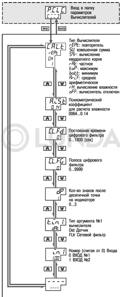
Рисунок 11.11 – Схема задания параметров Вычислителей
