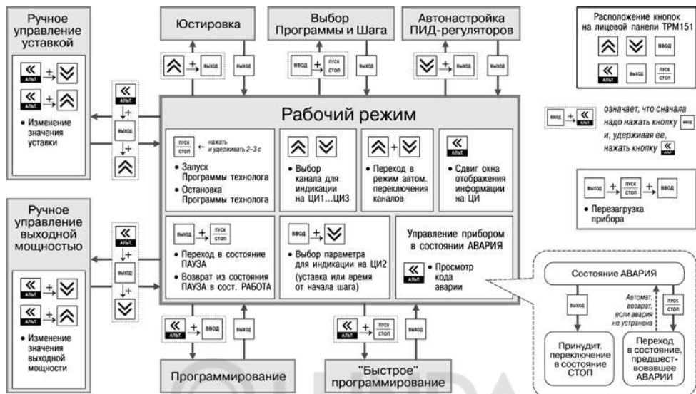
Рисунок 5.3 – Схема переключения режимов прибора
