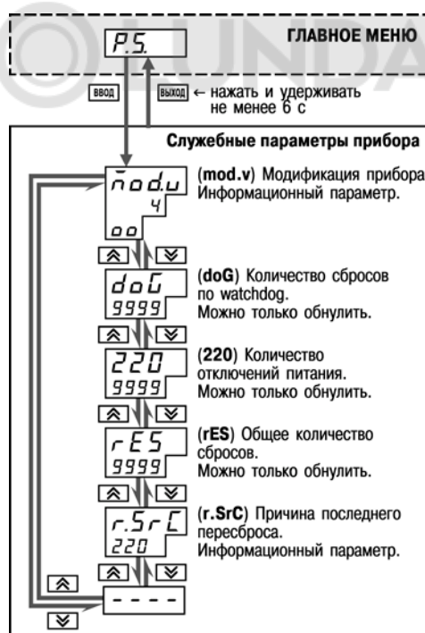
Рисунок 11.18 – Схема доступа к служебным параметрам прибора
