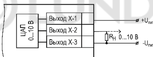
Рисунок 5.22 – Схема подключения нагрузки к ВУ типа У
