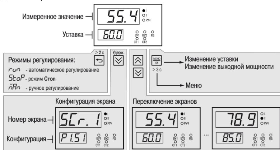
Рисунок 6.5 – Схема переходов с главного экрана
