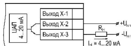
Рисунок 5.24 – Подключение к ВУ типа «И»
