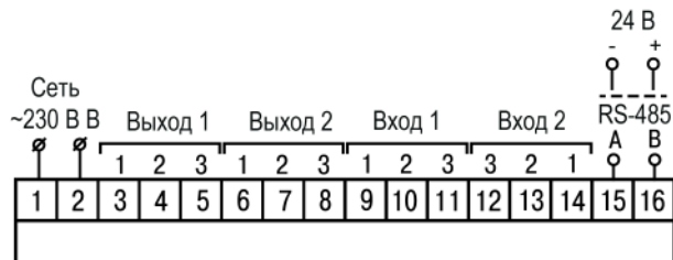
Рисунок 5.7 – Общая схема подключения TRM12–Н
