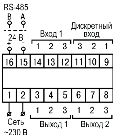
Рисунок 5.5 – Общая схема подключения TRM10–Щ5
