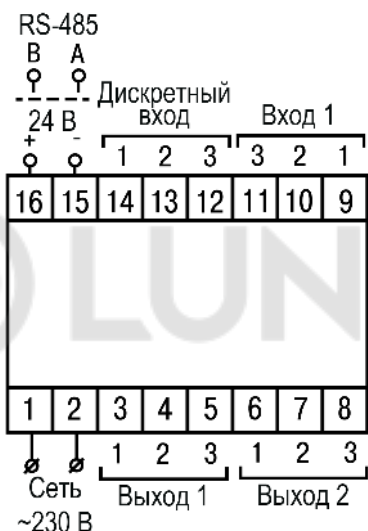
Рисунок 5.6 – Общая схема подключения TRM10–Д
