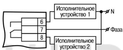
Рисунок 5.7 – Схема подключения нагрузки к ВУ типа «Р»
