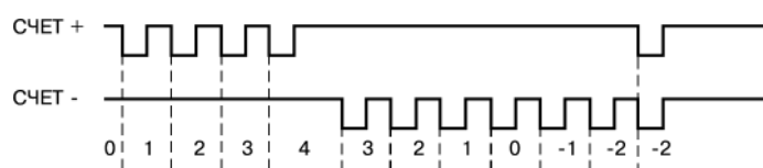
Рисунок 6.2 – Принцип работы входов «Счет+» и «Счет-»
