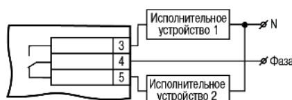
Рисунок 5.7 – Схема подключения нагрузки к ВУ типа Р
