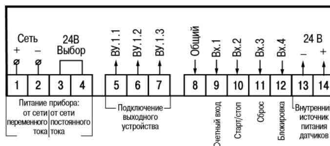
Рисунок 5.1 – Назначение контактов клеммника
