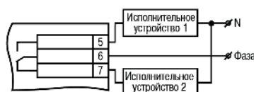
Рисунок 5.5 – Схема подключения нагрузки к ВУ типа Р
