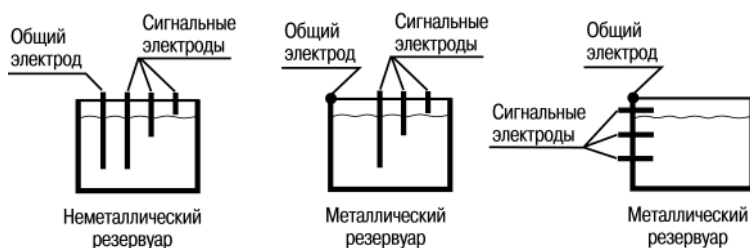
Рисунок 5.4 – Примеры установки кондуктометрических зондов
