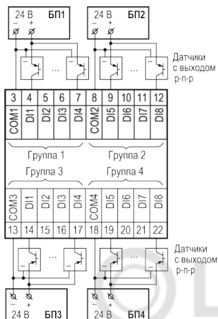
Рисунок 5.8 – Схема подключения датчиков с выходным транзистором р-п-р-типа
