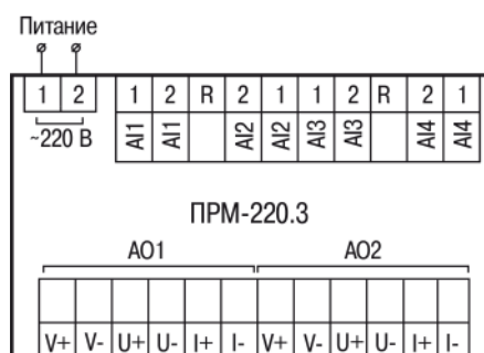
Рисунок 5.3 – Назначение контактов клеммника прибора с питанием 230 В
