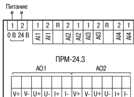
Рисунок 5.2 – Назначение контактов клеммника прибора с питанием 24 В
