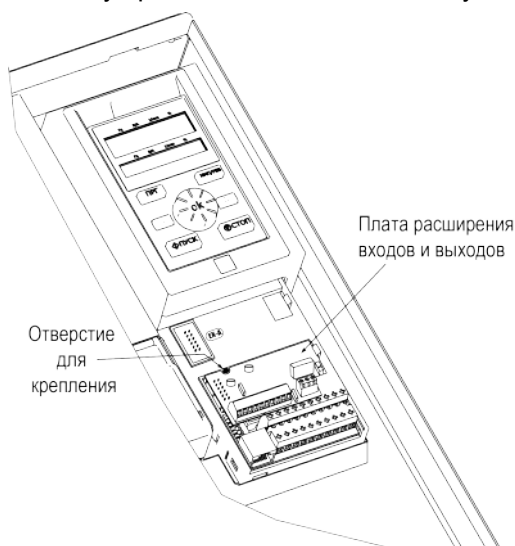
Рисунок 7.43 – Монтаж платы расширения входов и выходов
