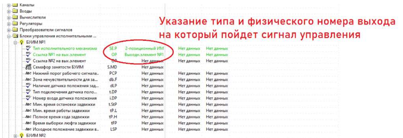
Рисунок 2.12 – Определение формата управляющего сигнала и номера выхода
