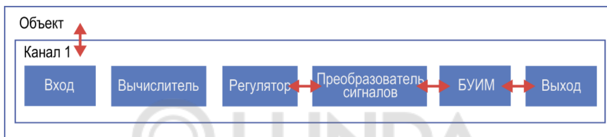
Рисунок 1.5 – Стрелочками обозначены связи, которые отслеживаются с помощью параметров семафоров
