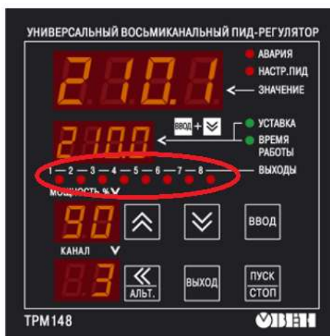
Рисунок 2.15 – Срабатывание ключевых ВУ сопровождается засветкой соответствующего светодиода
