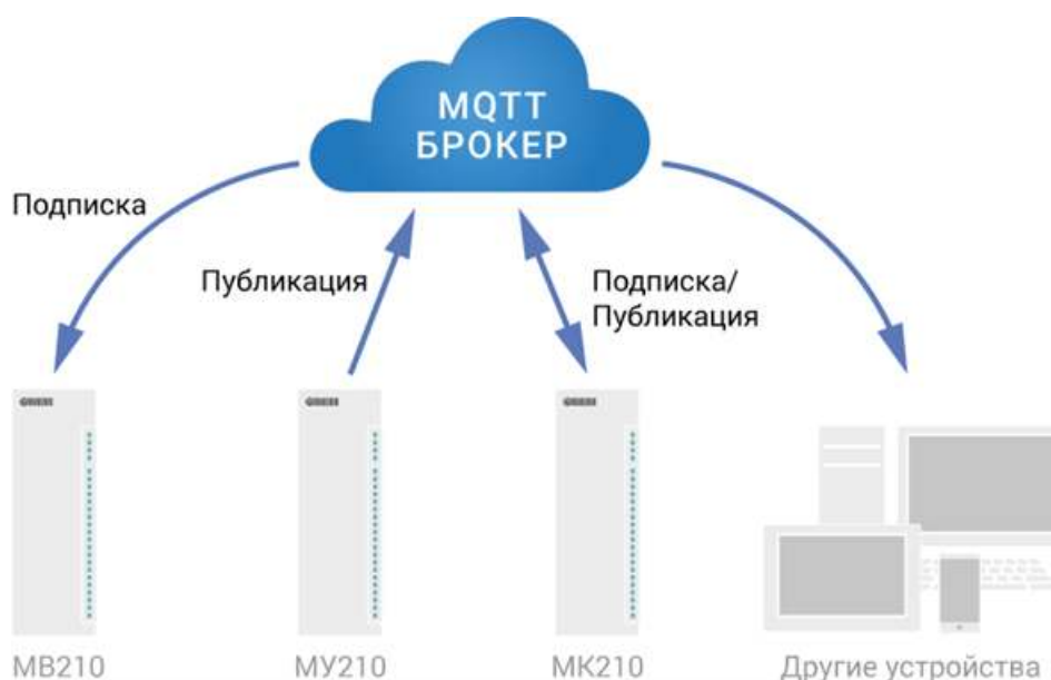
Рисунок 6.2 – Структурная схема обмена по протоколу MQTT
