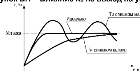
Рисунок Б.2 – Влияние \tau_{\text{И}} на выход на уставку
