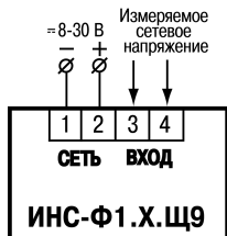
Рисунок 7 – Назначение клеммника прибора модификации Щ9
