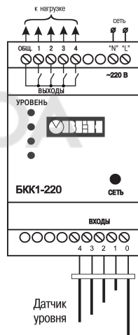
Рисунок 5.4 – Схема подключения БКК1-220
