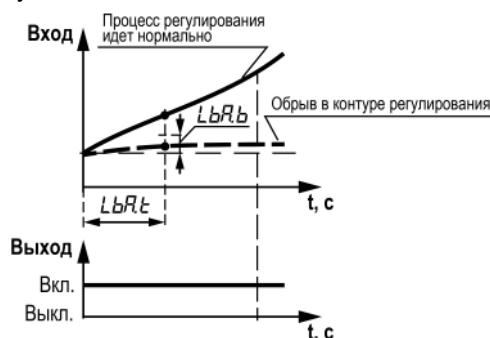
Рисунок 7.4 – Диагностика неисправности контура регулирования
