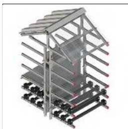
Крепление кабеля на эстакадах.
