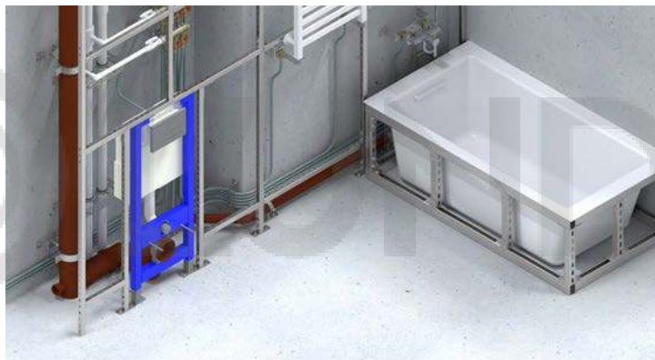
Крепление сантехнического оборудования и фальшстен
