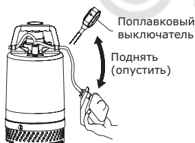
Рис. 10 Проверка направления вращения насоса с поплавковым выключателем
