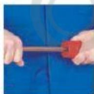
Очистить внутренние и наружные края трубы прибором для калибровки.
