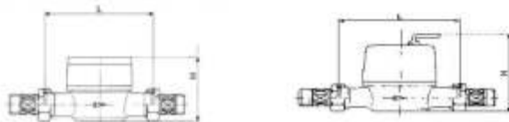
Рисунок 1. Габаритные и присоединительные размеры счётчиков воды BCX, BCXd, BCG, BCGd, BCT.
