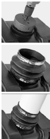
Рис. 8 Подсоединение вертикального подводящего трубопровода 110 мм (DN100)
