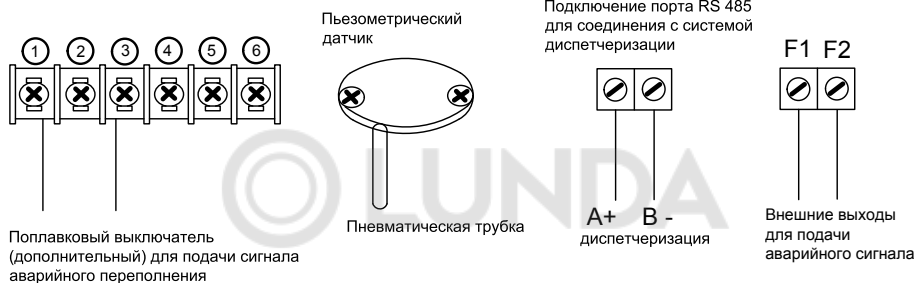
Рис. 13 Подключение реле уровня, порта диспетчеризации, внешней аварийной сигнализации
