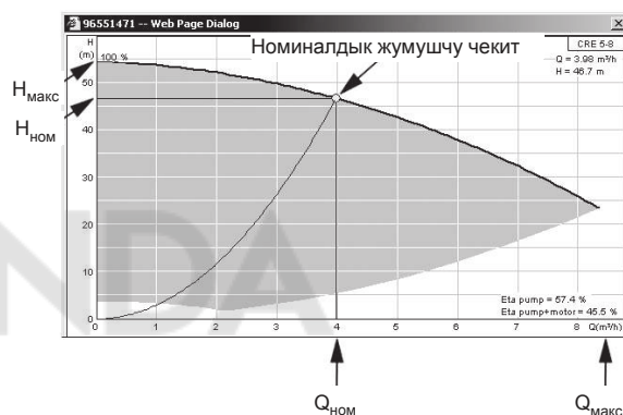
93-сур. Q_{ном} көрсөткүч, H_{ном} , H_{макс} жана Q_{макс}
