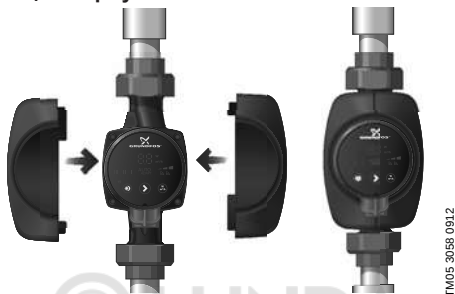
Рис. 8 Изоляция корпуса насоса
