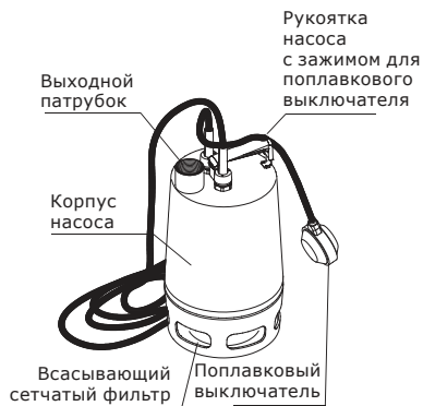
Рис. 1 Конструкция насосов APV.06 / APV.40 V
