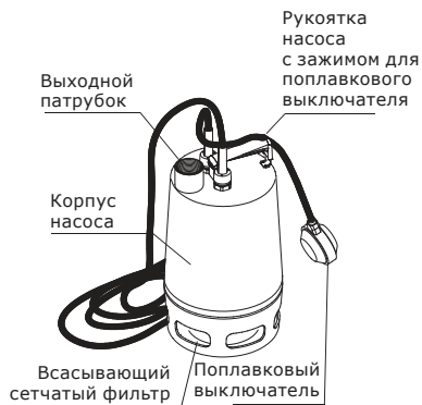
Рис. 1 Конструкция насосов APV.06 / APV.40 V
