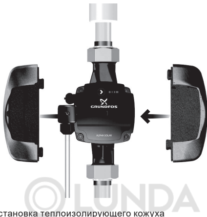
Рис. 8 Установка теплоизолирующего кожуха
