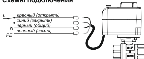
Электрическая схема подключения крана с электроприводом серии Neptun Profi Click 230B (рис. 3)
