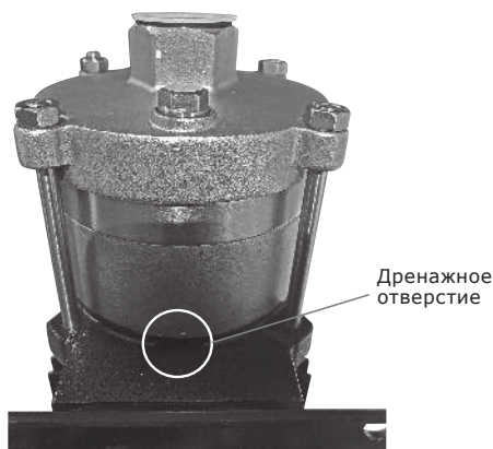
Рис. 10 Дренажное отверстие торцевого уплотнения
