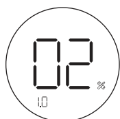
Рис. 28. Настройка отопительной кривой.
