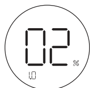
Рис. 20. Настройка отопительной кривой.
