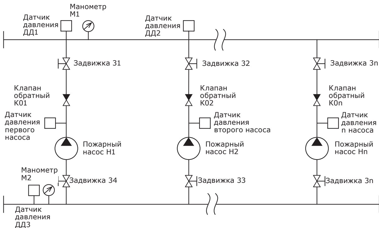
Рис. 3 Общая принципиальная схема установки Hydro-FS-V
