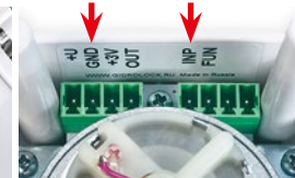
Фото 13. Клеммы подключения проводных датчиков — INP, GND
