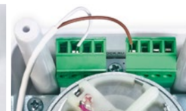
Фото 15. Подключение датчика к электроприводу
