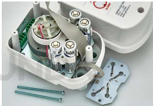
Фото 31. Контактная площадка снята, батарейки могут быть заменены
