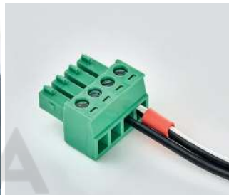
Фото 23. Подключение внешнего блока питания +12 В к ответной части разъема электропривода
