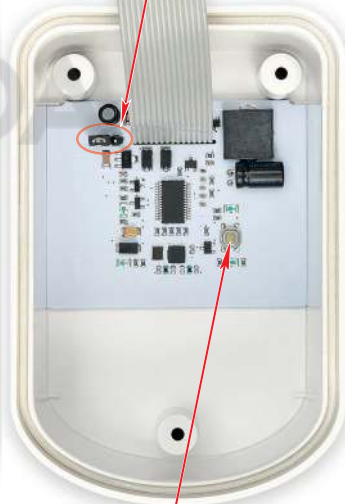
Фото 7. Элементы управления на внутренней стороне крышки шарового электропривода
