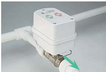
Фото 27, 28, 29. Ручное управление шаровым краном. Удаление металлического фиксатора для отсоединения электропривода от шарового крана и ручного управления шаровым краном.
