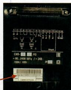
Рисунок 6 – Общий вид (сзади) счетчиков конструктивного исполнения Н с указанием места нанесения заводского номера
