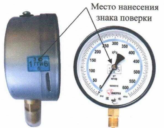
Рисунок 12 – Место нанесения знака поверки
