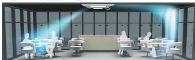
Сравнение направлений воздушного потока
