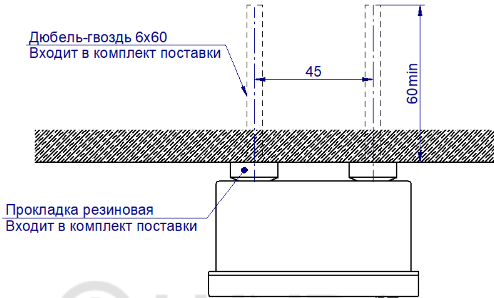
Рисунок 19. Схема монтажа датчика ТДВА к стене
