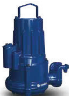
Lowara 1310 Non-clog Макс. расход 18 л/с Макс. напор 25 м Мощ. двиг. 1,4 - 2,4 кВт Напорн. патрубок 50 - 80 мм Вес 46 кг
