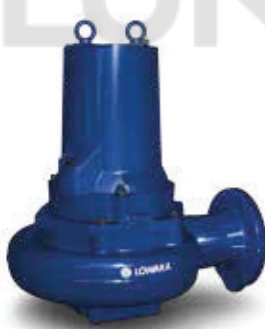
Lowara 1320 Non-clog Макс. расход 74 л/с Макс. напор 41 м Мощ. двиг. 3,5 - 7,5 кВт Напорн. патрубок 80 - 100 мм Вес 130-156 кг
