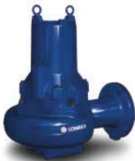
Lowara 1315 Non-clog Макс. расход 54 л/с Макс. напор 30 м Мощ. двиг. 1,8 - 4,4 кВт Напорн. патрубок 80 - 100 мм Вес 95 кг
