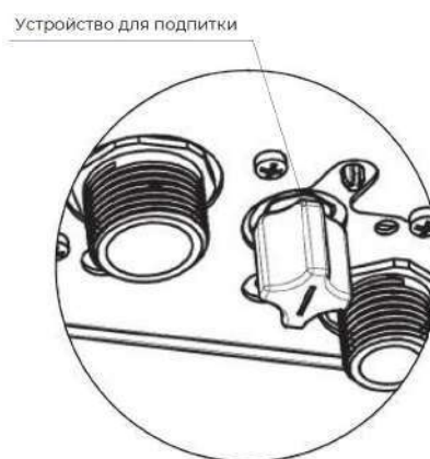
Рис. 11 Заполнение системы отопления (ГАЗ 6000 ..С RN)
