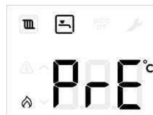
Рис. 19 Индикация подогрева вторичного теплообменника
