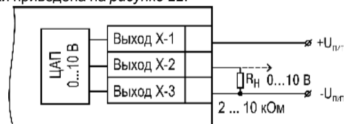
Рисунок 22 – Схема подключения нагрузки к ВУ типа У
