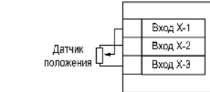
Рисунок 7 – Подключение датчика положения резистивного типа
