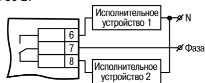
Рисунок 12 – Схема подключения нагрузки к ВУ типа «Р»
